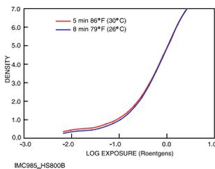
**Belichtung:** 220 kV Direkte Röntgenbestrahlung mit Bleifolien
