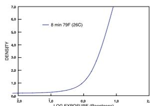
**Belichtung:** 220 kV Direkte Röntgenbestrahlung mit Bleifolien
