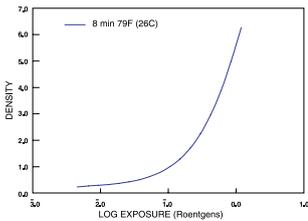
**Belichtung:** 220 kV Direkte Röntgenbestrahlung mit Bleifolien
