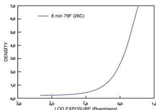
**Belichtung:** 220 kV Direkte Röntgenbestrahlung mit Bleifolien
